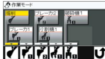
アタッチメント取付け時の煩雑な油圧回路切替えや流量切替は、「作業モード選択」画面からワンタッチ操作で行えるため、ブームや車体の上でのバルブ切替作業は不要です。
