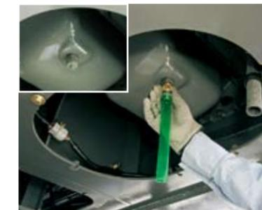
エンジンオイルパンにドレンカバーを装備。備え付けのノズルホースにより、容易にドレン作業が行えます。
