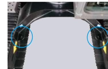
輸送時の機械固定用フック穴をトラックフレームの下フランジ部前後計4カ所に設けました。
