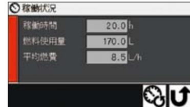
前回は行った給油時からの稼働時間、燃料使用量、平均燃費をモニタに表示します。
