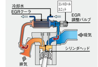
一度燃焼させた排出ガスの一部を吸入空気
