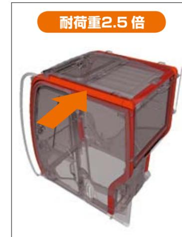
キャブの強度、剛性が大幅にアップした転倒時運転者保護構造を採用し、転倒に対する安全性を向上。この構造は、日本のJCMASが規定する安全基準(EOPS)に適合しています。例えば、キャブ上部部に横方向の荷重を加えた場合、従来機ZAXISに比べ2.5倍の荷重に耐えることができます。
