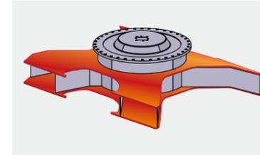
上下板には1枚板の曲げ構造を採用しました。溶接部を減らすことで、Xビーム構造全体の信頼性が向上しました。
