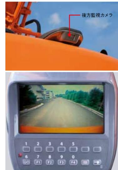
カウンタウイト部に後方監視カメラを搭載。キャブ内のモニタに後方の映像を表示できます。
